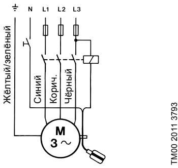
**Рис. 9 Схема электрических соединений**
