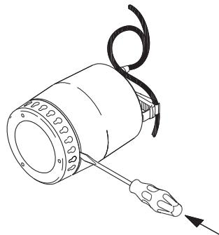
Рис. 11 Снятие сетчатого фильтра на всасывающей линии
