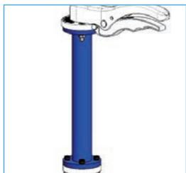
KPRO9 - Удлинитель для выхода наружу / *Stem extension for water main system connection*
