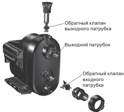
Рис. 23 Обратные клапаны входного и выходного патрубков
