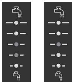
Рис. 14 Индикация давления нагнетания SCALA2
