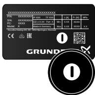
Рис. 34 Обозначение главной головной части на фирменной табличке (заводская установка)
