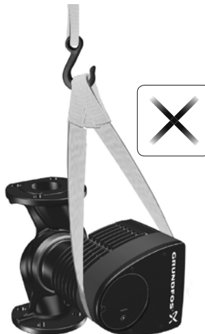
Рис. 10 Неправильный способ стропки насоса
