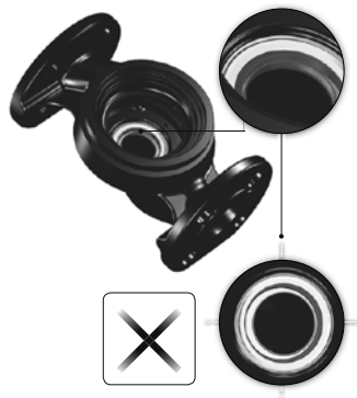
Рис. 17 Неправильно выровненная система уплотнений
